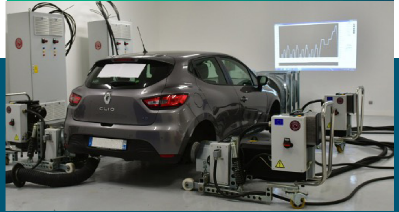
Figure 6 : banc d'essais véhicules
