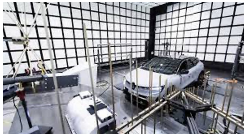
Figure 5 : chambre d'essais de compatibilité électromagnétique
